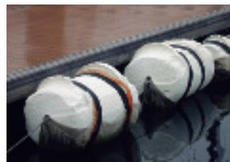
発泡スチロール製のフェンダーは紫外線や摩擦、衝撃に弱く耐久性が低い。マリーナの傍らでボロボロになっているのをよく見かけるが、これが海に流れ出すとマイクロプラスチックゴミとなる
