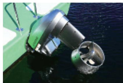
リムドライブのHARMOは垂直の動力軸がないため、約70度の舵角がとれ、非常に小回りがきく
