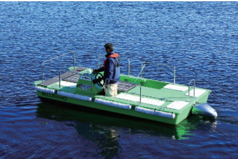
真四角で平らなフォルムは、双胴のハルの間にゴミを入れるために導き出された形。電動ドライブのHARMOで音もなくマリーナ内に漂うゴミをキャッチする
