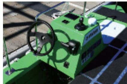
操船にはスロットルとステアリングホイールの他、ジョイスティックでも行える。速度調節は5段階
