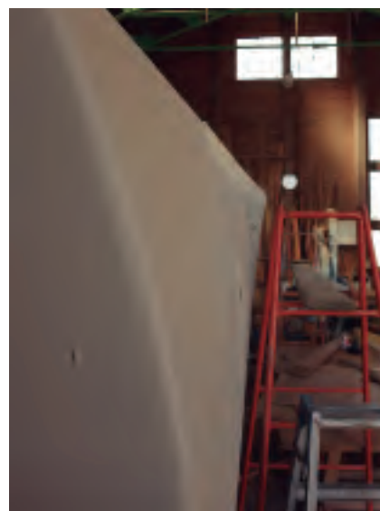
建造中のクルーザーを右舷船尾から見た様子。佐野造船所の特徴であるタンブルフォームが美しい
