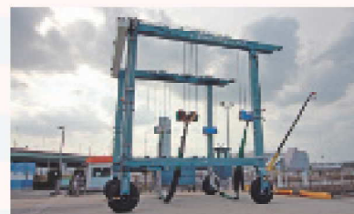
ボート・ヨットの上下架には自走式50トンクレーンを整備
