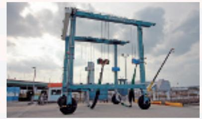
ボート・ヨットの上下架には自走式50トンクレーンを整備
