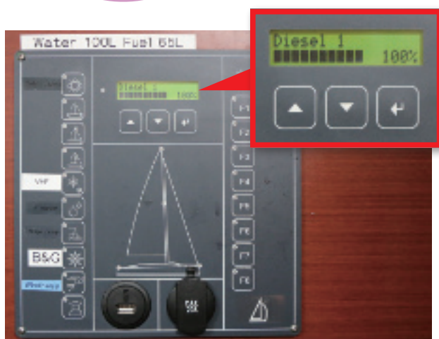
デジタル燃料メーターの一例。表示部分はデジタルだが、タンク側のセンサーはアナログ機構となっているのが一般的だ
