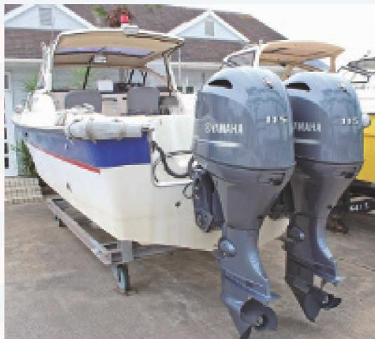
レスキュー艇に搭載されるエンジンは115馬力4ストローク船外機の2基掛け。通常走航で30ノットオーバー。大きな牽引力がレスキューに力を発揮する
